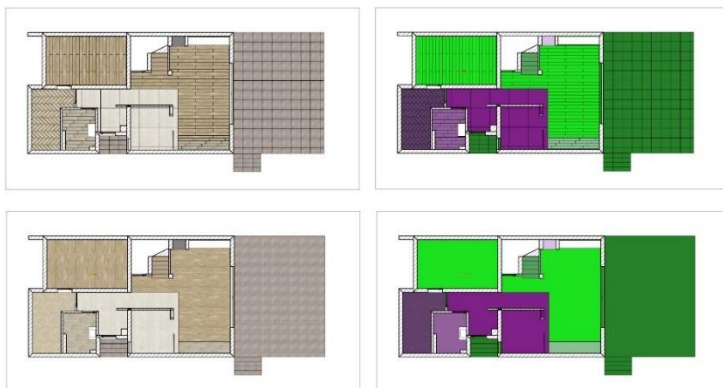
Rys. 616 – różne przedstawienia obszarów pokrytych płytkami – od lewej: tekstura z obrysem fug, kolor z obrysem fug, tekstura bez obrysu, kolor bez obrysu
