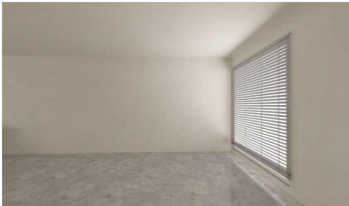
Rozkład światła przy żaluzjach zdefiniowanych jako materiał jednostronny (scena po obliczeniach Radiosity)
