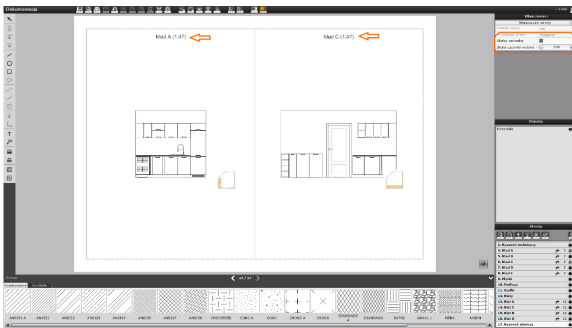
Rys. 17 - Informacja o skali rysunków i zaznaczone opcje skalowania
