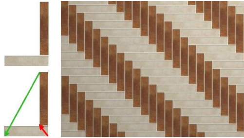
Rys. 660 – tworzenie układu płytek w „jodełkę”
